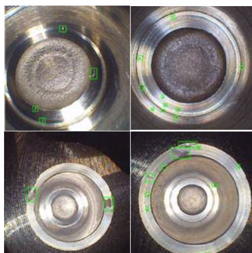
FIGURA 3 Exemplos de porosidade no interior dos furos.
