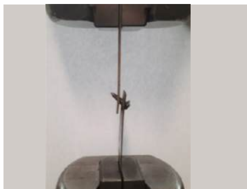
FIGURA 11 Resultados dos ensaios de tração (shearing tests): comportamento típico da ligação.
