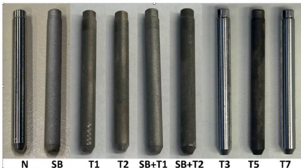
FIGURA 2 Aspecto geral dos insertos após modificação superficial.
