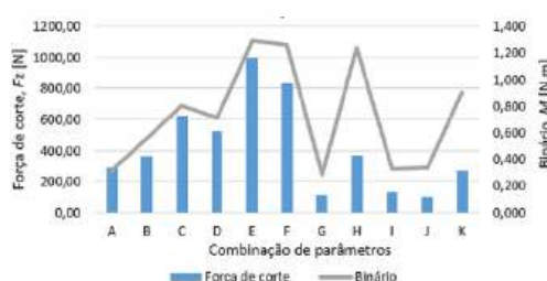
FIGURA 2 Valores máximos de força de corte e binário obtido durante os ensaios de furação.
