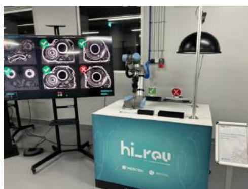
FIGURA 1 Sistema de inspeção desenvolvido nas atividades do projeto Hi-rEV.
