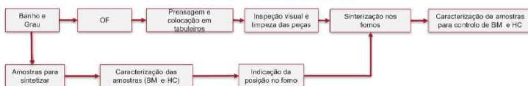
FIGURA 3 Diagrama do processo de sinterização.
