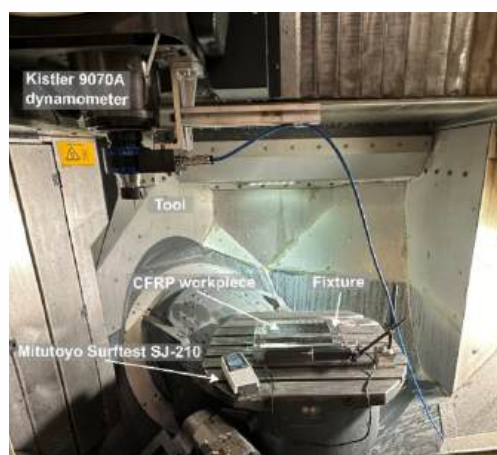
FIGURA 1 Aparato experimental usado nos ensaios instrumentados de fresagem.
